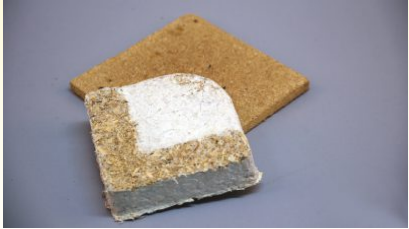
Pilzmaterialien von ecovative Mycofoam (weiss) und Mycoboard (braun)
